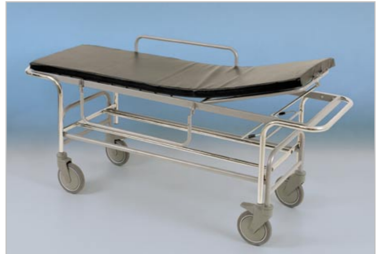
■ ART. 210 - BARELLA SU CARRELLO + ART. 225 - MATERASSO PER BARELLA Carrello costruito in tubo tondo Ø 30x1.5mm montato su ruote con freno Ø 200mm. Barella struttura in acciaio cromato di tubo tondo Ø 30x1.5mm. Piano rete in tubo rettangolare Ø 40x20x1.5mm; rete metallica a maglia quadrata con molloni di tensione perimetrale. Alzatesta regolabile mediante cremagliera a scatto. Completo di spondine laterali ribaltabili. Dim. 190x65x75h.
