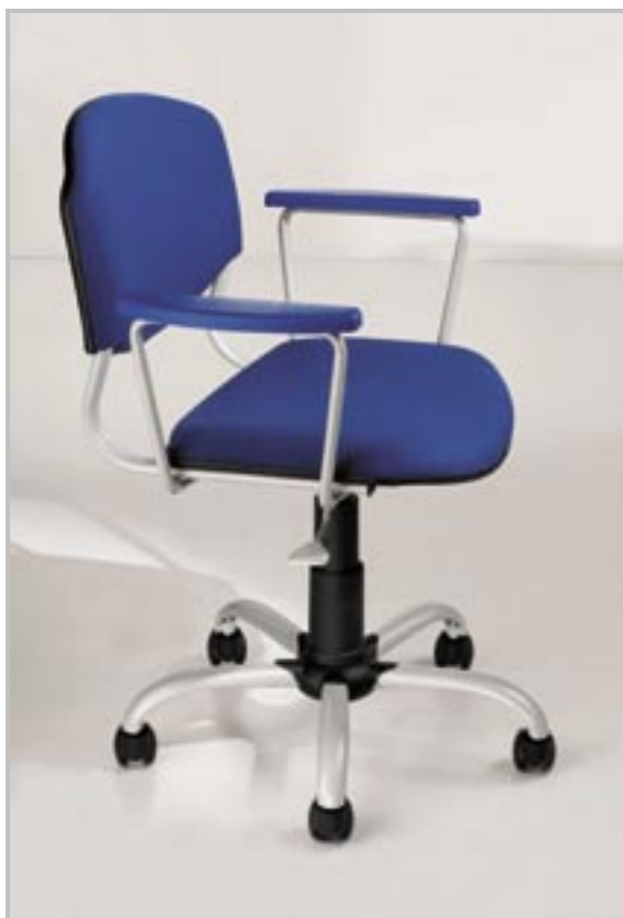
SERIE F.G.F. ART. 58/M (TAPPEZZATO) Poltroncina con braccioli in tubo di acciaio Ø 14x2mm con copribra- cciolo in materiale plastico, girevole su ruote con alzo gas e base a cinque razze in nylon. DIMENSIONI: altezza totale cm 77/88 - altezza seduta cm 40/51 larghezza cm 54 - profondità cm 54.5
