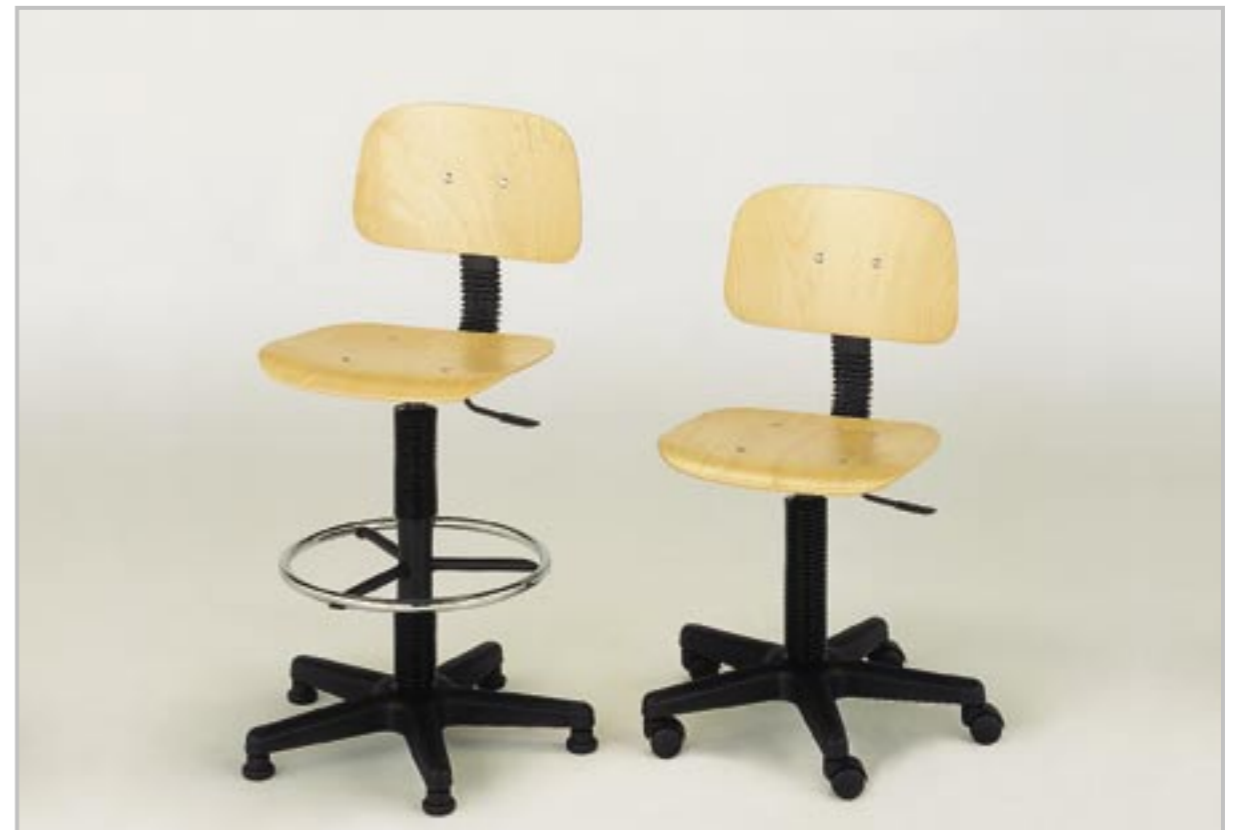
ART. T/SGR14cF - Sedia (dattilo) con cerchio poggiapiedi girevole su piedini con alzo gas e base a cinque razze in nylon. Sedile e schienale in faggio. DIMENSIONI: altezza totale cm. 78/82 - altezza seduta cm. 45/49 - larghezza cm. 40 - profondità cm. 51
