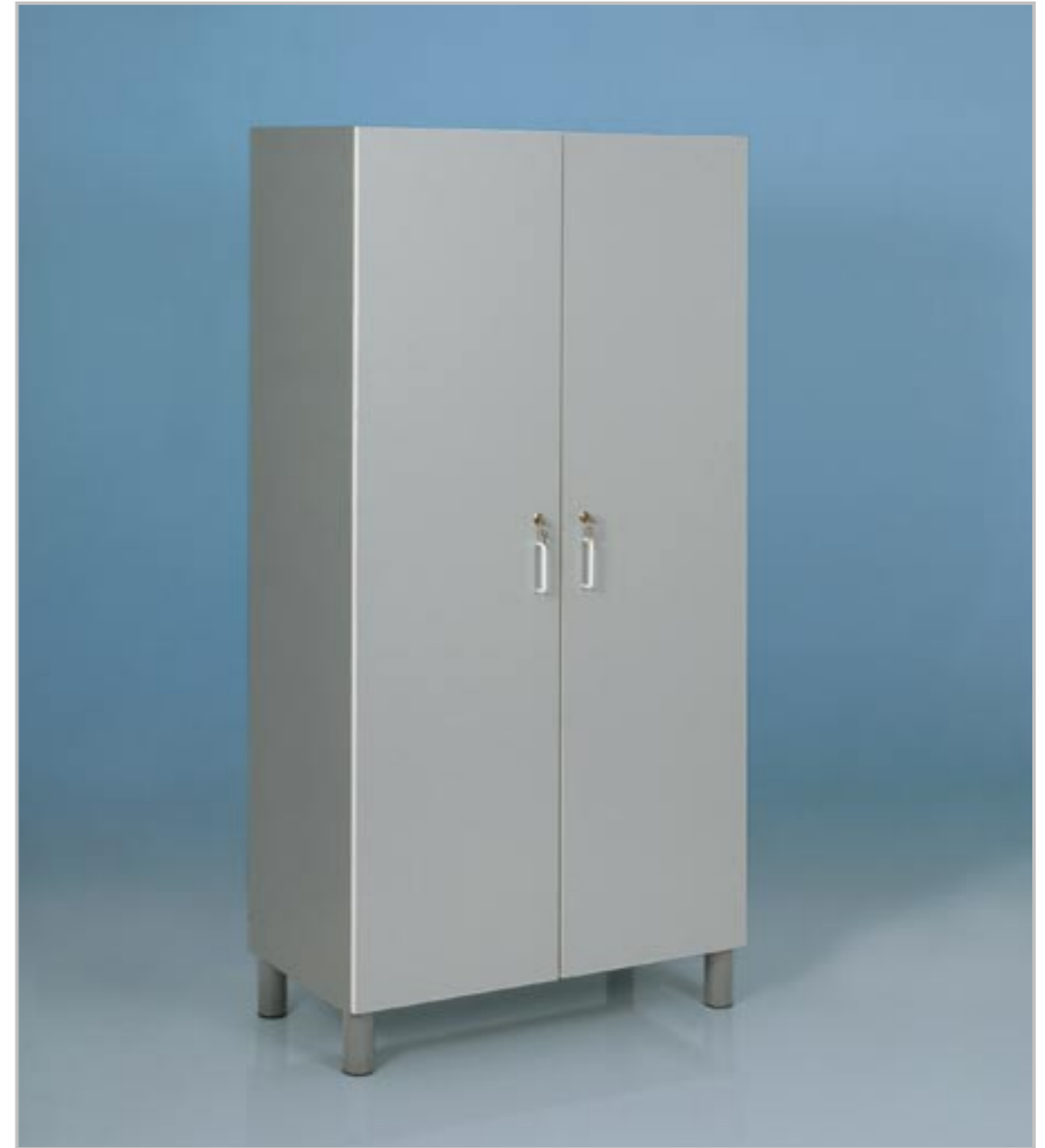
ART. 618 - ARMADIO DEGENZA 2 ANTE Struttura in acciaio verniciato con polveri epossidiche spessore 8/10 di colore grigio o bianco. Ante in bilaminato con bordo perimetrale in ABS montate su cerniere girevoli e serratura a doppia chiave. Le gambe sono realizzate in tubolare Ø 60x1.5mm con puntali antiscivolo. Dim. 90x45x190h.
