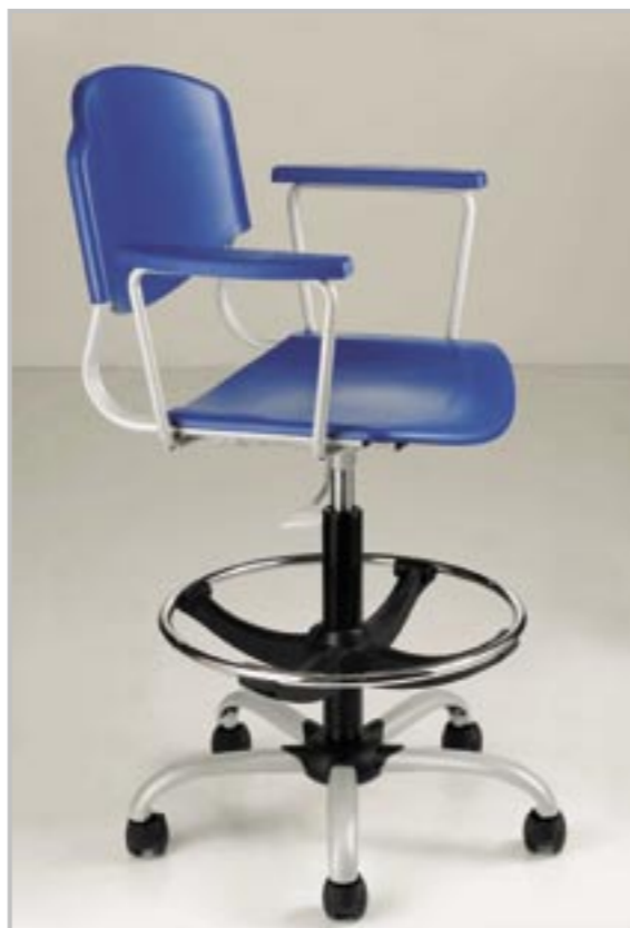
SERIE F.G.F. ART. 59/C (POLIPROPILENE) Poltroncina con braccioli in tubo di acciaio Ø 14x2mm con copribra- cciolo in materiale plastico, girevole su puntali e base a cinque razze in nylon con cerchio poggiatesta. DIMENSIONI: altezza totale cm 100/111 - altezza seduta cm 62/73 larghezza cm 54 - profondità cm 54.5
