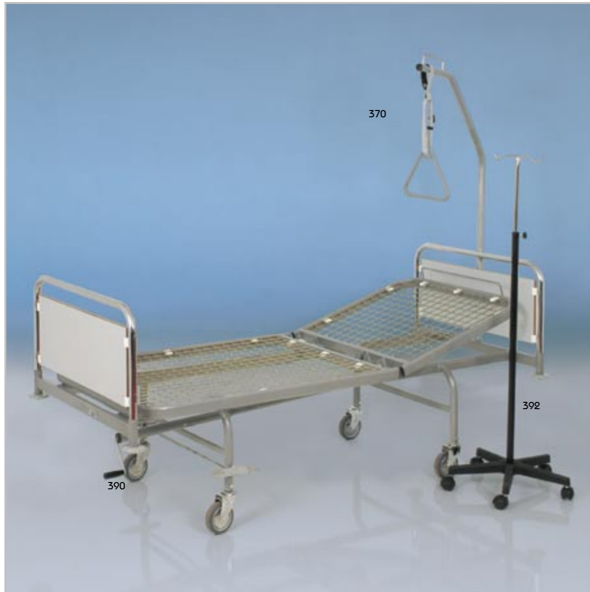
■ ART. 322 - LETTO A 1 SNODO E 2 SEZIONI (alzatesta regolabile a manovella) Struttura in tubo ovale mm. 50x25 costruito con materiale di adeguato spessore eliminando spigoli per facilitare il buon funzionamento. Il tutto verniciato con polveri epossidiche a forno a 200° Testiera e pediera asportabili in tubo di acciaio cromato, pannelli in laminato plastico estraibili con alla base paracolpi in gomma. Piano rete in pannelli di tondino di acciaio zincato asportabili. Regolazione delle sezioni mediante spintoni a vite indipendenti con manovella rientrante Dim. 205x90x55h. ■ ART. 370 - ASTA SOLLEVA AMMALATI DA LETTO UNIVERSALE ■ ART. 392 - ASTA PORTAFLEBO SU RUOTE
