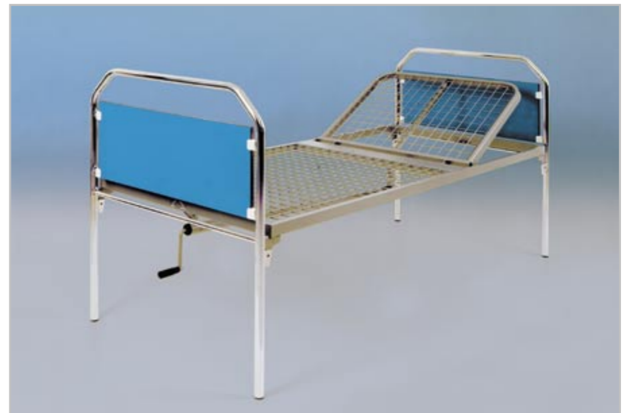
■ ART. 310 LETTO A 1 SNODO E 2 SEZIONI (alzatesta regolabile a manovella) Struttura portante perimetrale esterna costruita in profili di acciaio a sezione rettangolare 50x20x1.5mm. Telaio sezioni mobili in tubo di acciaio semi ovale 40x20x1.5mm. Telo rete rigido in tondino di acciaio Ø 5mm a maglie quadrate 50x50mm elettrosaldato. Piano rete a due sezioni; sezione alzatesta regolabile a mezzo di spintone a vite con manovella rientrante. Testiera e pediera asportabili ad innesto in tubo di acciaio cromato Ø 30mm; pannelli asportabili in laminato plastico a spessore 10mm. Verniciatura con polveri epossidiche a forno a 200°. Dim. 200x90x55h.
